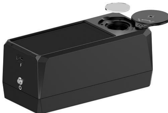
Рисунок 5-3. Виймання забрудненого або пошкодженого струмопровідного скла
